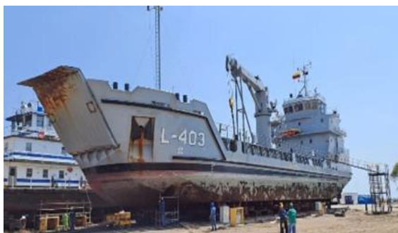
Mantenimiento Sistema de propulsión, esquema de pinturas, instalación de Pana Shocks y del nicho del ancla de popa, entre otros
