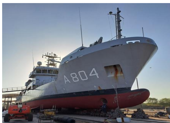
Mantenimiento válvulas; Sandblasting y esquema pintura casco; limpieza, rutina mecánica y pintura tanques de lastre; instalación nuevo ecosonda (suministrada por cliente), entre otros.
